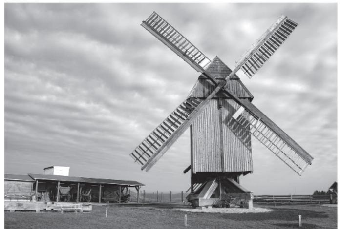
2016 erfolgte der Einbau der neuen Jalousieflügel. Dadurch wurde der historische Zustand der Flügel wieder hergestellt. Die Mühle kann nun schneller und einfacher in Betrieb genommen werden.
